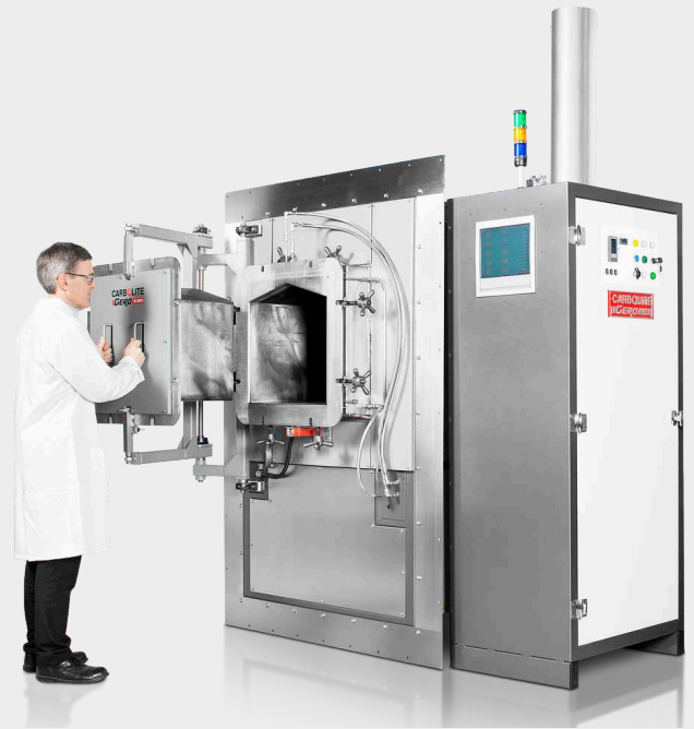
GPCMA /174 avec système de gaz contrôlé par PLC, écran tactile HMI et post-combustion avec sortie de gaz chauffée. Conçu pour s'adapter à l'ouverture murale d'une salle blanche.
