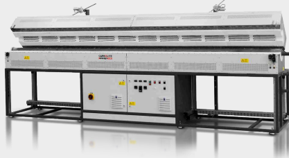
FZS 13/100/4500 de diseño personalizado, de 3 zonas con una longitud de calentamiento de 4500 mm, mecanismo de apertura automática y tubo de trabajo APM
