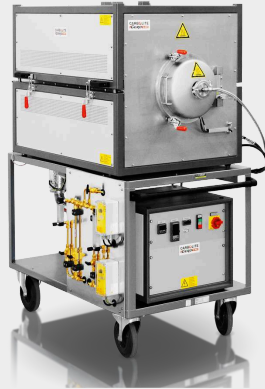
GLO 10/11-IG: Horno de recocido compacto, con retorta de acero inoxidable y retorta opcional de Inconel (vacío hasta 750°C y presión normal hasta 1100°C)
