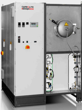
GLO 40/11-IG semiautomático con una temperatura máx. de 1100°C
