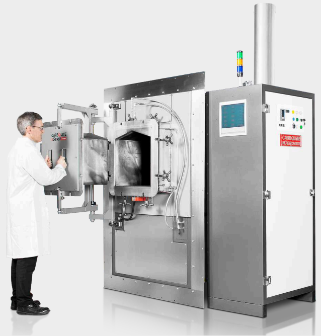
GPCMA / 174，带有PLC控制的气氛系统，HMI触摸屏和尾气燃烧火炬和带加热的废气管道。炉门开口位于洁净室内。
