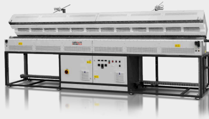
Specjalnie zaprojektowany 3-strefowy piec FZS 13/100/4500 z 4500 mm strefą grzania, automatycznym otwieraniem oraz rurą z APM.
