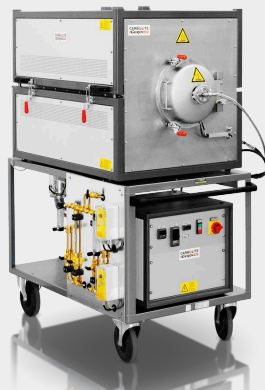
GLO 10 / 11-1G: Kompaktní horkostěnná pec s nerezovou retortou a volitelnou inkonelní retortou (vákuum až 750 ° C a normální tlak do 1100 ° C)
